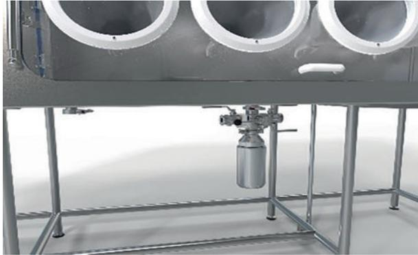
Fig. 8. Salida producto pesado a través de válvula mariposa partida.
