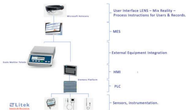
Fig. 9. Arquitectura del Sistema de Control.
