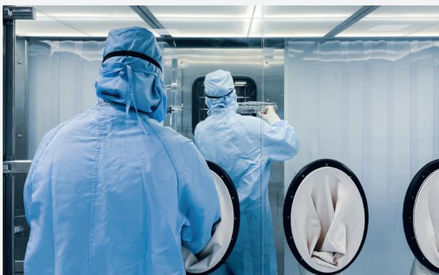
Figura 1. Carga manual de bandeja metálica con viales de producto en un liofilizador ubicado dentro de una zona con entorno aséptico y aislamiento físico mediante RABS.
