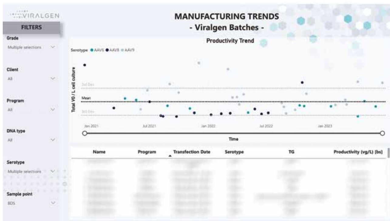
Figura 1. Dashboard para supervisar la productividad de los lotes e identificar tendencias por tipo de producto. Este panel permite a los usuarios acceder a datos de lotes sin procesar, realizar análisis de producción y personalizar visualizaciones según necesidades e intereses.
