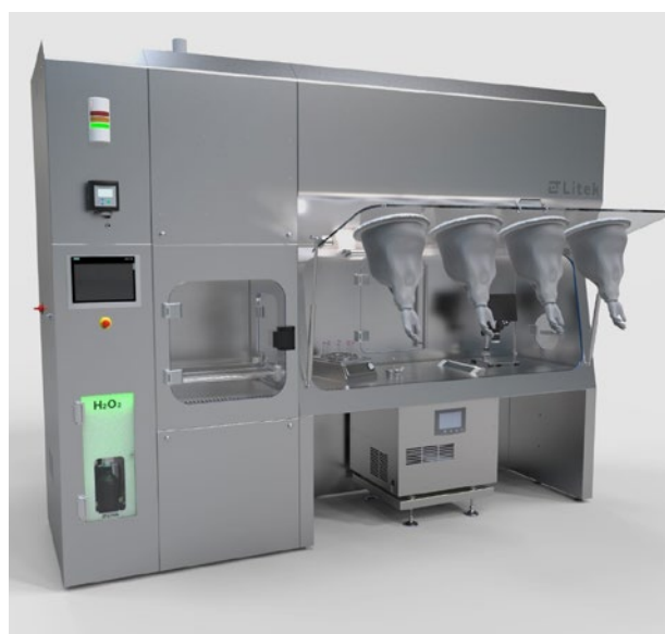
Figura 1: Aislador Terapias Avanzadas para producción de células mesenquimales, con equipamiento integrado.
